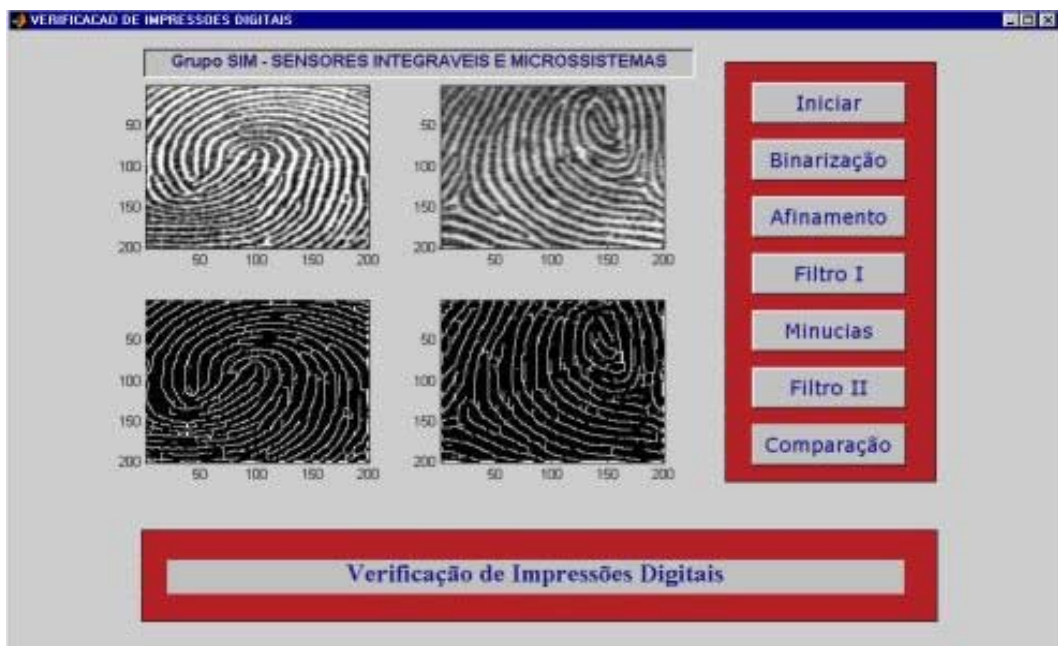
Figura 62: Interface gráfica após afinamento e aplicação do filtro para limpeza do esqueleto.
