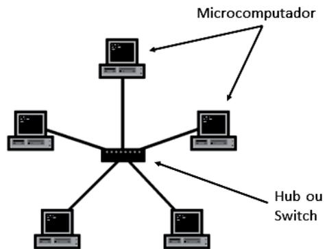
A conexão dos microcomputadores ao hub ou switch é realizada
